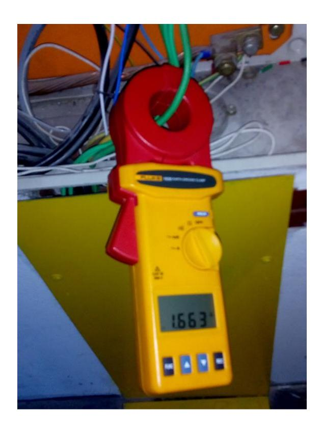
Cabo terra da Cemig medidores de KW/H, segue para os Quadros de Disjuntores das lojas e salas do condomínio. Resistência Ohms= 1,941  $\Omega$
