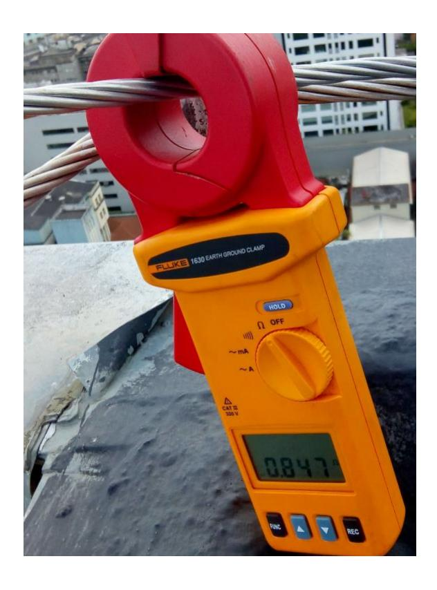
Cabo terra Quadro Elevador " A " . Resistência Ohms= 0,502  $\Omega$  Medição feita em 19/02/2018
